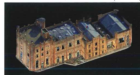
Vue de Tremplin Entreprises (ancienne brasserie) en nuage de points, grâce au scanner 3D de l'entreprise D-TECH
